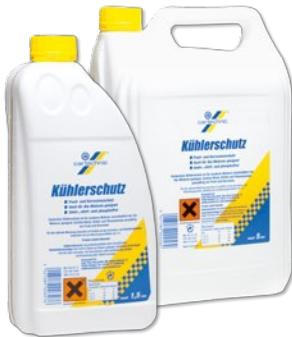
Cartechnic Kühlerschutz schützt das ganze Jahr zuverlässig vor Frost und Überhitzung. Er eignet sich für Motoren aus Gusseisen, Aluminium oder die Kombinationen beider Materialien und für Kühlsysteme aus Aluminium- und Kupferlegierungen. Der Cartechnic Kühlerschutz ist frei von potenziell schädlichen Stoffen wie Nitriten, Aminen und Phosphaten. Frostschutz bis -36° Celsius bei einer Mischung von 1:1.
