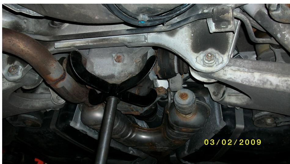
Schrauben der Tonnenlager auf einer Seite herausdrehen (im Bild rechte Seite)
