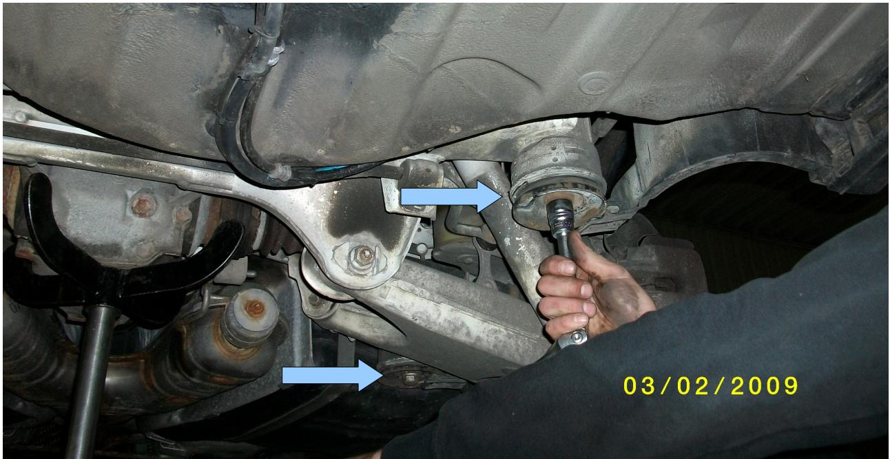
Den Getriebeheber langsam ablassen, wenn die Schrauben gelöst sind. Nur soweit ablassen, wie nötig ist, um die obere Scheibe des Abziehers oberhalb des Lagers aufzusetzen.
