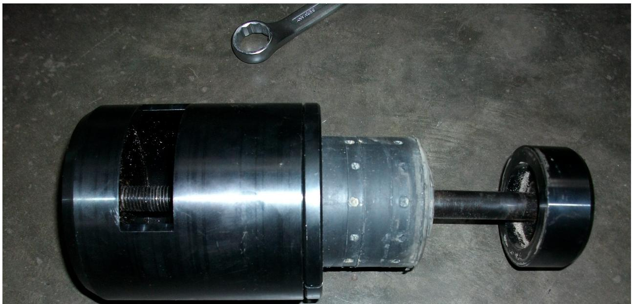
Das Einsetzen der neuen Lager sollte mit Hilfe von Reifenmontagepaste oder Schmierseife erfolgen.
