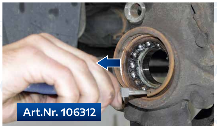
Bild 4: Alten Sprengring entfernen
