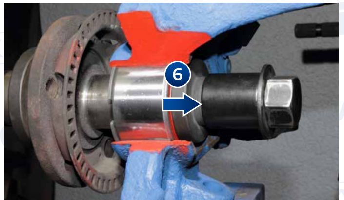
Bild 8: Radnabe wieder einziehen
