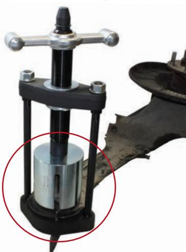
Das **Einpressen** erfolgt mithilfe der unteren Platte 100661 – mit Stufe (Bestandteil Pressrahmen).
