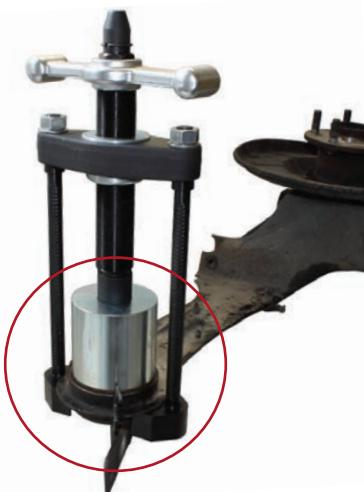
Das **Auspressen** erfolgt mithilfe der unteren Platte 106624 – ohne Stufe (Bestandteil Erweiterungssatz).
