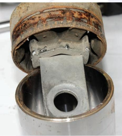
Zum **Auspressen** wird die Presshülse 106487 – ohne Stufe – benötigt.
