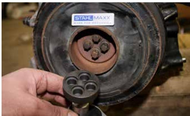
ANSCHLUSSSTÜCK ZUM DURCHDREHEN DES MOTORS
