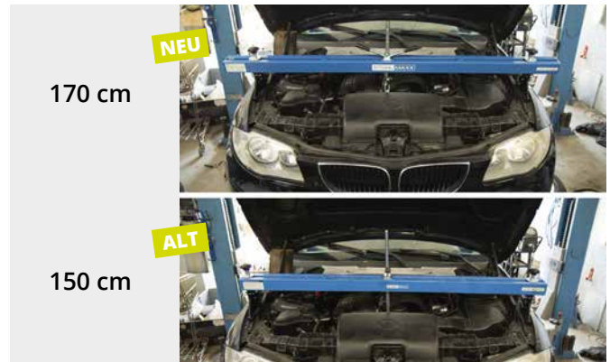
LÄNGENVERGLEICH ZU EINER STANDARD-MOTORBRÜCKE
