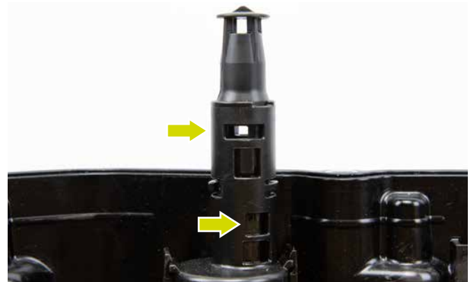
POSITION 2: Öl ablassen, kleine Menge, zur Ölstandskontrolle
