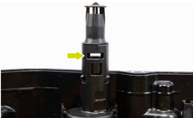
POSITION 3: Öl ablassen, mittlere Menge, zur Ölstandskorrektur
