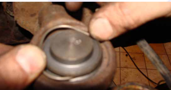
11: NICHT VERGESSEN: Sprengring wieder einsetzen!
