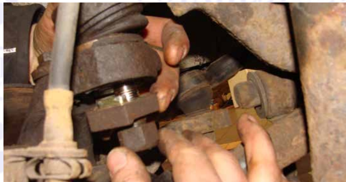
2: Die Mutter vom Traggelenk lösen und entfernen.
