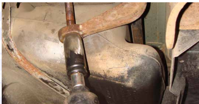
4: Position an Gewinde-Spindel abmessen und notieren. Fahrwerk entlasten und beim zusammenbauen auf alte Stellung spannen.
