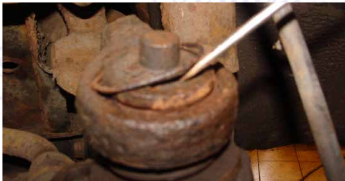
1: Sicherungsring vom Traggelenk oben entfernen.
