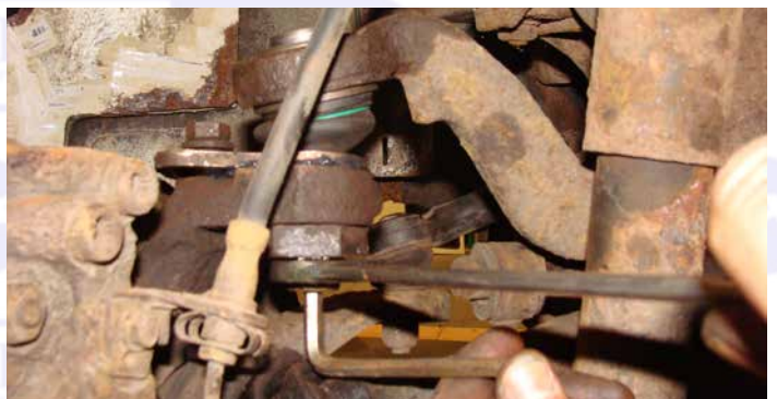
12: Zusammenbauen und Fahrwerk auf alte Position drehen. Sturz und evtl. Spur einstellen. FERTIG!
