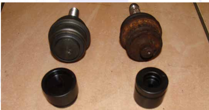
5: Passendes Druckstück beim Auspressen verwenden. ACHTUNG: es gibt 2 Varianten!
