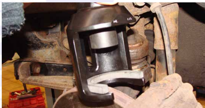
6: Schwarzes Hufeisen zum Ausbauen des Traggelenks im Abzieher verwenden.
