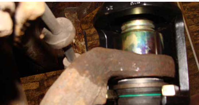
9: Abzieher mit goldenem Hufeisen bestücken und neues Traggelenk einpressen.
