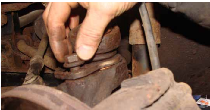
3: Schraube zum Einstellen vom Sturz lösen und entfernen.
