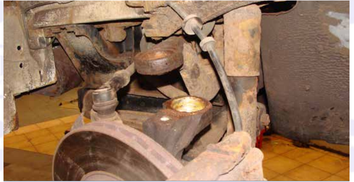
8: Nun ist das Traggelenk ausgebaut.
