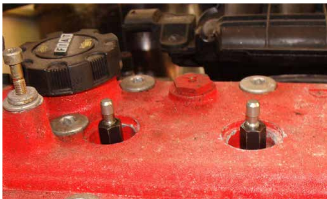
AUSRICHTWERKZEUG FÜR KOLBENPOSITION KT10056
