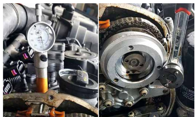
ADAPTER FÜR MESSUHR 16014 / MESSUHR 21036 / WERKZEUG FÜR NOCKENWELLENVERSTELLER 104922
