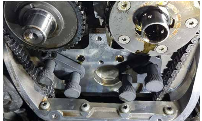
NOCKENWELLENFIXIERUNG FÜR KETTENRÄDER 106257
