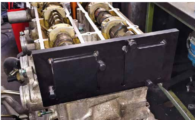
EINSTELLVORRICHTUNG 117468 MIT HALTEFEDERN 117469
