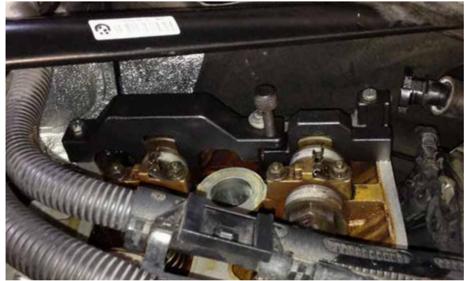
FIXIERWERKZEUG FÜR NOCKENWELLEN 121116
