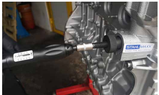
VORSPANNWERKZEUG 118790A UND DREHMOMENTSCHRAUBER 106650
