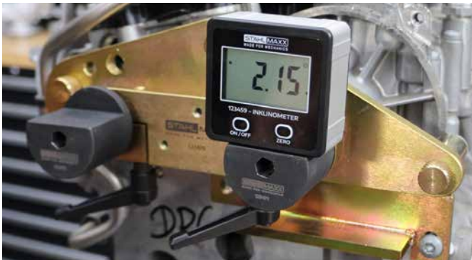
GRUNDPLATTE 123470, MESSADAPTER 123471, EINSTELLWINKEL 123473, INKLINOMETER 123459, ABSTANDSHÜLSEN 123474
