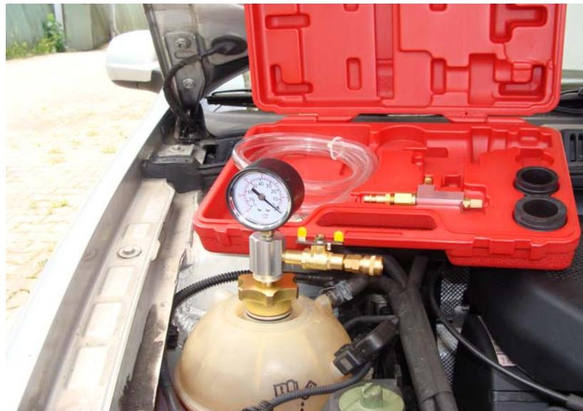
2. Dann die Vakuum Pumpe an den Druckadapter anschließen und den Druckluftschlauch vom Kompressor mit der Vakuum-Pumpe verbinden und das Ventil am Druckadapter aufdrehen.
