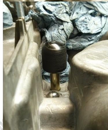
Nun kann der Injektor mit neuen Original-DB-Dehnschrauben wieder befestigt werden.
