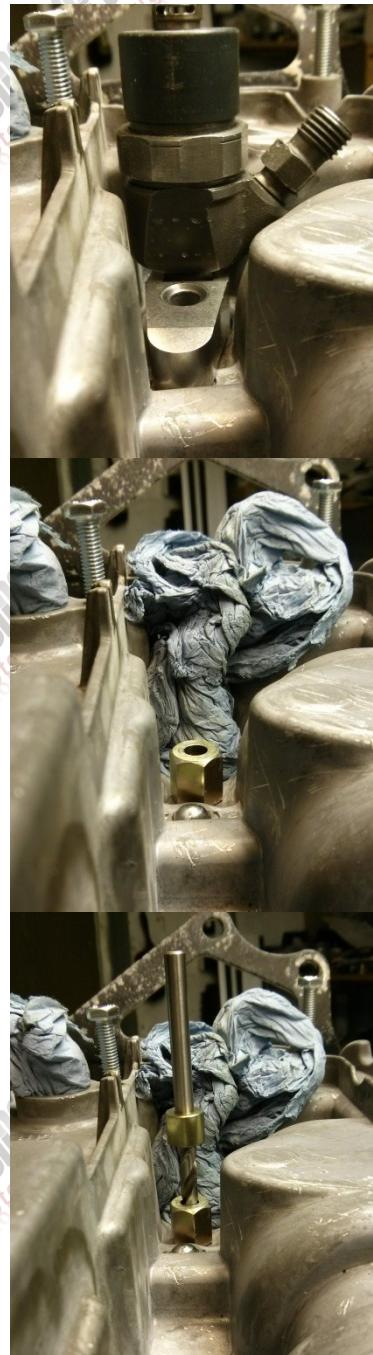
Der abgesetzten Kernlochbohrer 8mm/7mm vergrößert nun im Kopf die 6er-Bohrung auf Kernlochgröße für M8x1.
